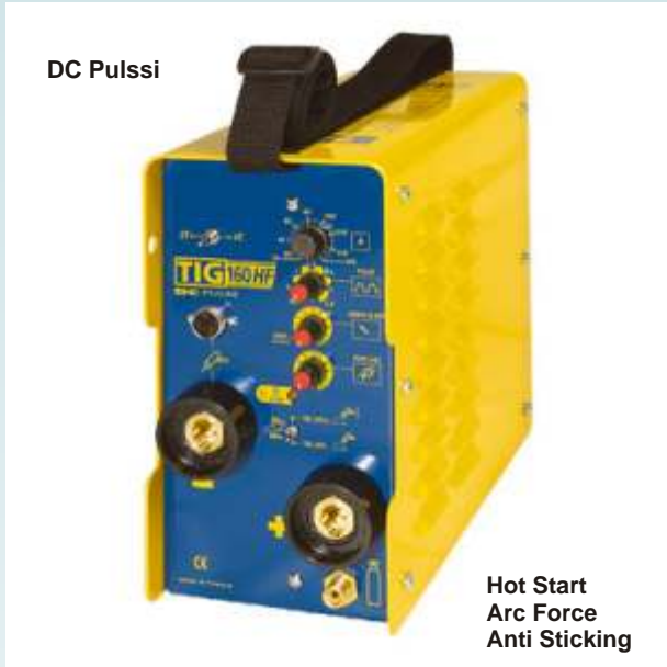
Tig -160 A DC esim. ruostumattomien terästen hitsaukseen HF-sytytys, puikkohitsausalue 1.6 - 4.0 mm 10 - 160 A, lopetusvirran säätö (down slope), kaasun jälkivirtauksen säätö (post - gas).
