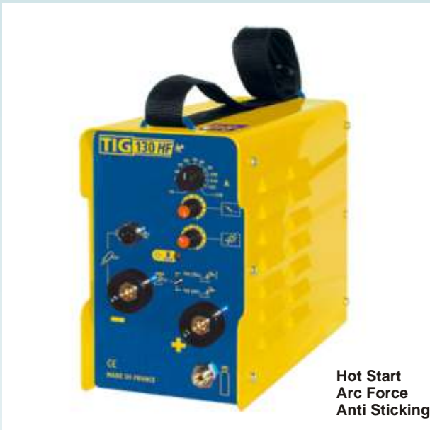
Tig -130 A DC esim. ruostumattomien terästen hitsaukseen, HF-sytytys, puikkohitsausalue 1.6 - 3.2 mm 10 - 130 A, lopetusvirran säätö (down slope), kaasun jälkivirtauksen säätö (post - gas).
